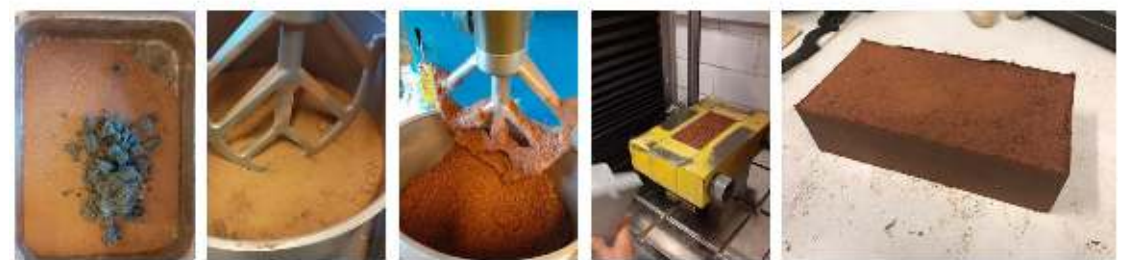
Terre criblée et laine broyée à 6 mm | Mélaxage à sec | Mélaxage humide | Mise en place dans le moule | Brique mixte
