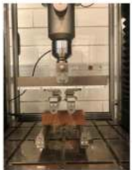
Essai de flexion 4 points sur brique
